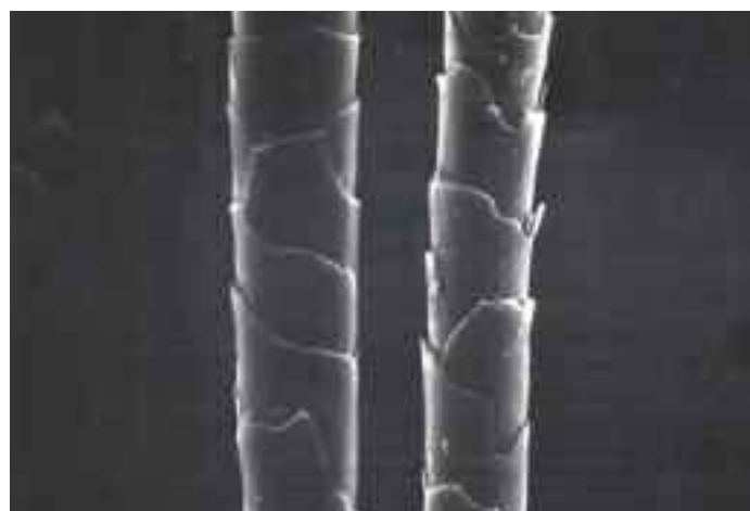
Foto 2. Fibre di cashmere viste al SEM 1000X (foto: C. Vineis, CNR – ISMAC, Biella, 2015).
